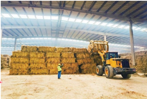
环保发电额上公司生物质料场管理人员现场指挥做好燃料定置化存储工作
